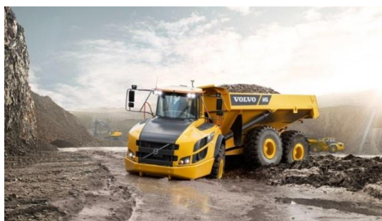
6.1 Сурет - Volvo A45G (жүк көтергіштігі 45 т) автосамосвалы
